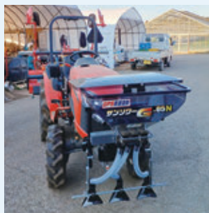
トラクター装着型GPS車速連動付き肥料散布機
