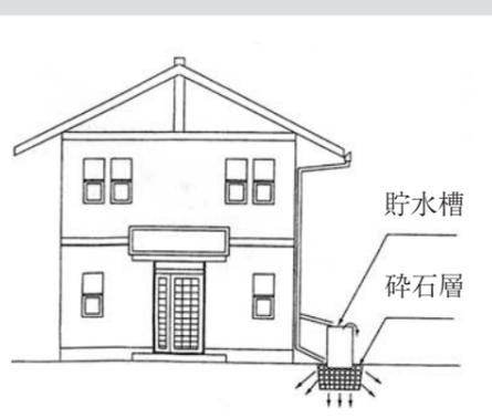
屋根雨水を雨樋で貯水槽に導き雨水利用をはかるとともに、あふれた分は碎石層を通して地中へしみこませる施設例
