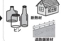
びんにはリターナブルびんとワンウェイ びんがあります。リターナルびんは洗 浄・殺菌し、中身を詰め、びんとして利 用されます。ワンウェイびんやガラスは 破砕してカレットにしてから溶かし、成 型して新しいびんや断熱材、道路舗装材 などになります。
