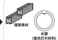
電池は解砕され外缶(外側の金属部分) 水銀、亜鉛・マンガンなどに分けられま す。外缶は製鉄所へ送られ鉄筋などの鉄 製品になります。水銀は蛍光灯製造工場 に送られ蛍光灯の材料などに使われます。
