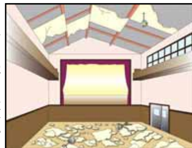
天井崩落の危険性
