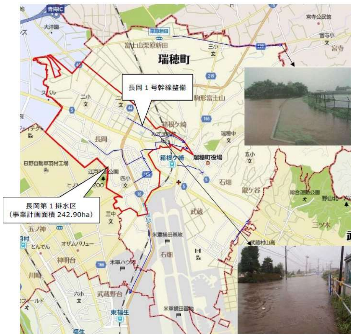
図 3-3 瑞穂町の雨水事業概要図 (出典：瑞穂町雨水総合管理計画)
