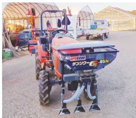
スマート農業に向けた補助金を活用して導入されたトラクター装着型GPS車速連動付き肥料散布機
